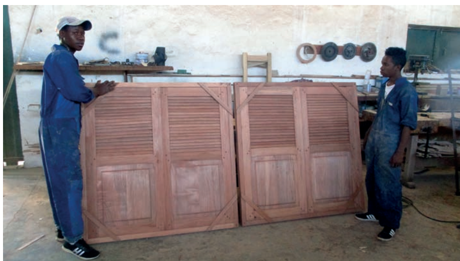
Die auszubildenden Zimmerleute fertigten Fensterläden als Jahresarbeit an. (Foto: PATMAD)
