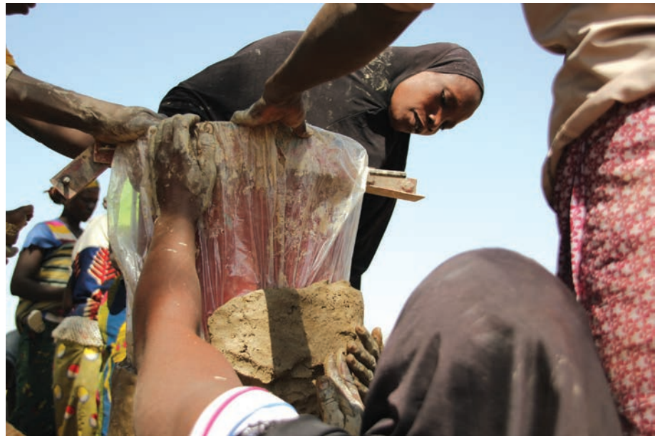
Suivant l'exemple de Mariam Zalé, les potières façonnent l'argile autour du moule préparé à l'avance (photo : P. Kohler)
