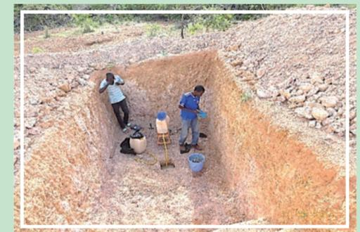
PHOTO 2 : Réalisation test de perméabilité lors de l'étude pédologique pour la réalisation de la décharge à PO
